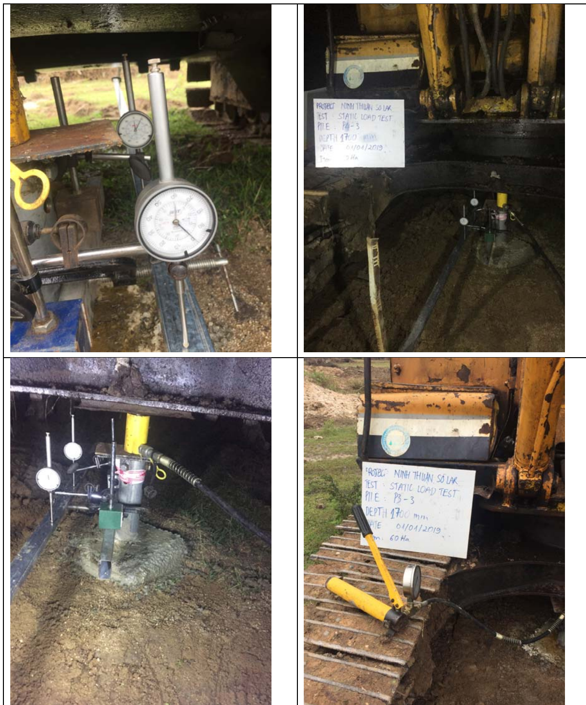
Thí nghiệm cọc đơn dưới tác dụng của tải trọng nén dọc trục
