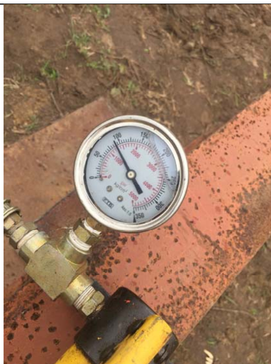
Thí nghiệm cọc đơn dưới tác dụng của tải trọng kéo dọc trục Standard test method for invidual piles under static axial tensile load
