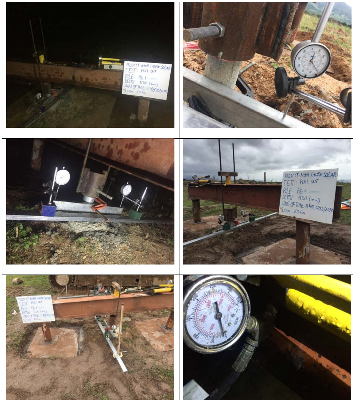
Thí nghiệm cọc đơn dưới tác dụng của tải trọng kéo dọc trục Standard test method for individual piles under static axial tensile load
