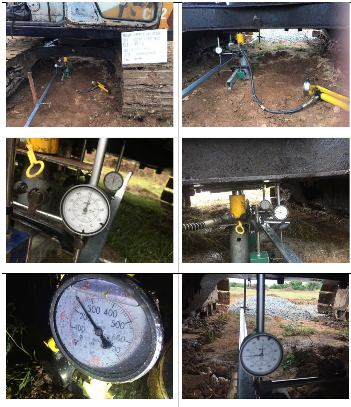
Thí nghiệm cọc đơn dưới tác dụng của tải trọng nén dọc trục
