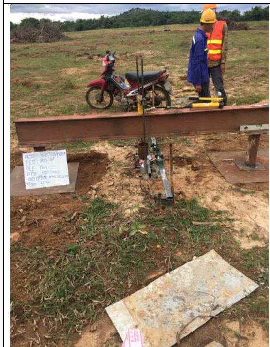
Thí nghiệm cọc đơn dưới tác dụng của tải trọng kéo dọc trục Standard test method for invidual piles under static axial tensile load
