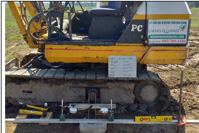
Số đọc đồng hồ ban đầu/Gauge reading at 0% Design Load
