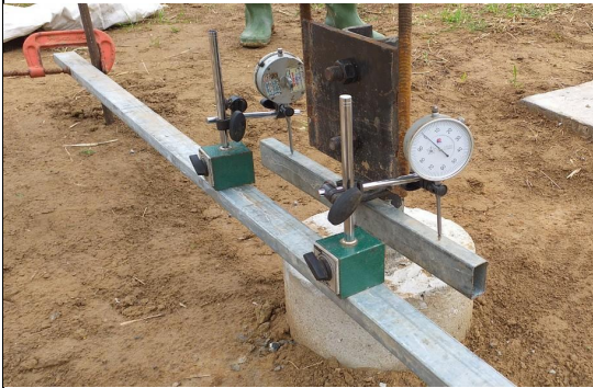
Số đọc đồng hồ tại cấp tải 200%/Gauge reading at 200% Design Load
