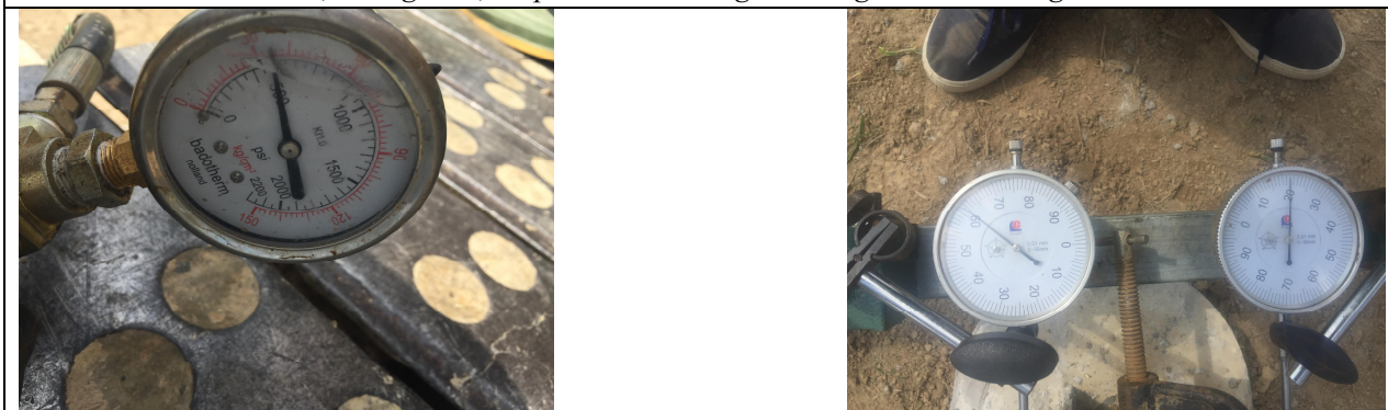
Số đọc đồng hồ tại cấp tải 200%/Gauge reading at 200% Design Load
