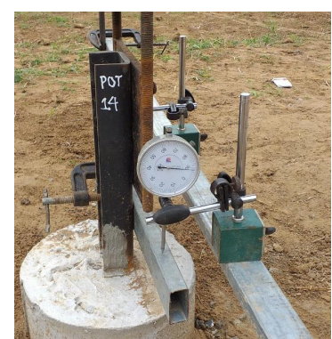
Số đọc đồng hồ tại cấp tải 100%/Gauge reading at 100% Design Load
