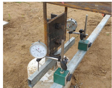
Số đọc đồng hồ tại cấp tải 200%/Gauge reading at 200% Design Load
