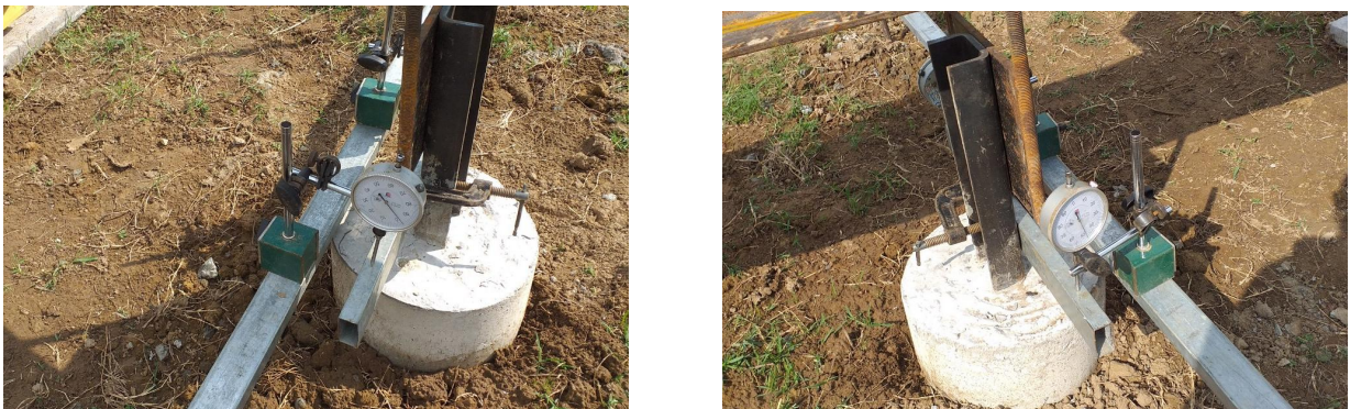
Số đọc đồng hồ tại cấp tải 100%/Gauge reading at 100% Design Load
