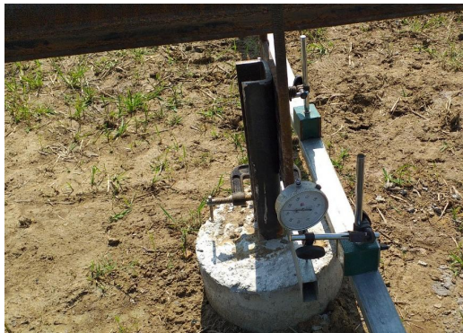
Số đọc đồng hồ tại cấp tải 200%/Gauge reading at 200% Design Load
