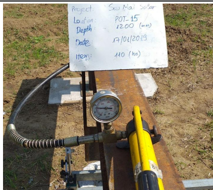
Số đọc đồng hồ ban đầu/Gauge reading at 0% Design Load
