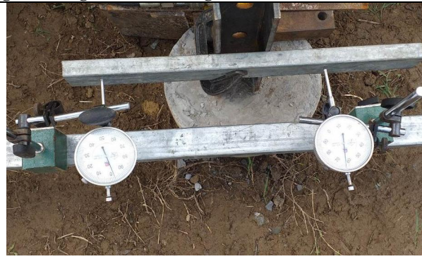
Số đọc đồng hồ tại cấp tải lớn nhất (275%Ptk)/Gauge reading at applied Load max (275%Ptk)
