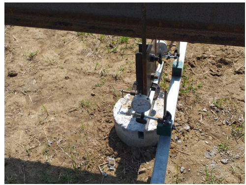
Số đọc đồng hồ tại cấp tải 100%/Gauge reading at 100% Design Load
