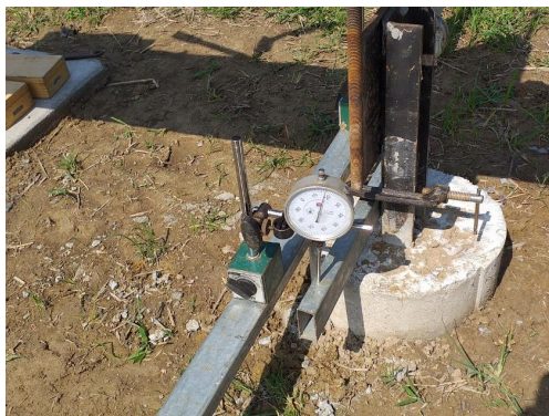
Số đọc đồng hồ tại cấp tải 100%/Gauge reading at 100% Design Load
