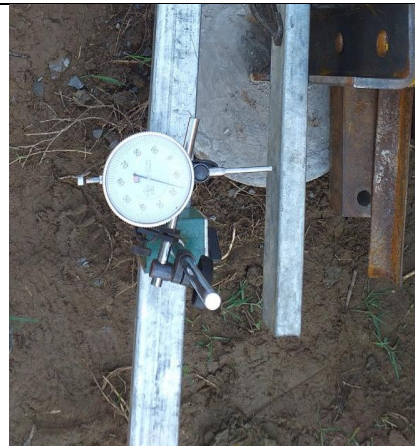
Số đọc đồng hồ ban đầu/Gauge reading at 0% Design Load
