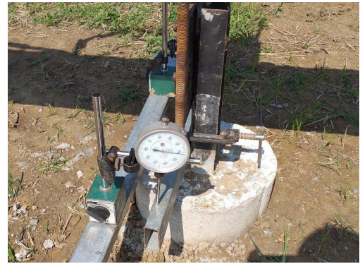
Số đọc đồng hồ tại cấp tải 200%/Gauge reading at 200% Design Load
