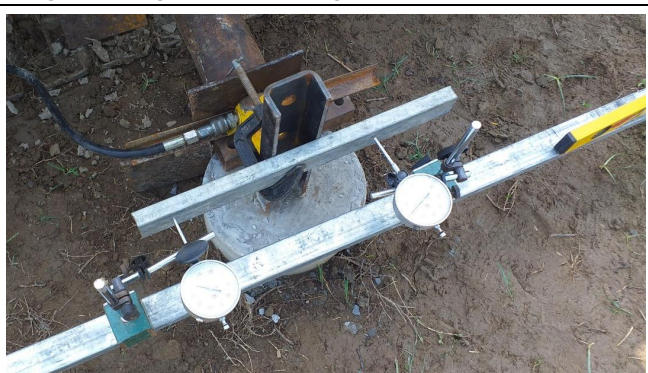
Số đọc đồng hồ tại cấp tải 200%/Gauge reading at 200% Design Load
