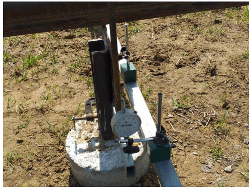
Số đọc đồng hồ tại cấp tải 200%/Gauge reading at 200% Design Load
