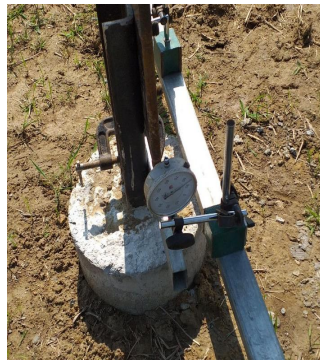
Số đọc đồng hồ ban đầu/Gauge reading at 0% Design Load
