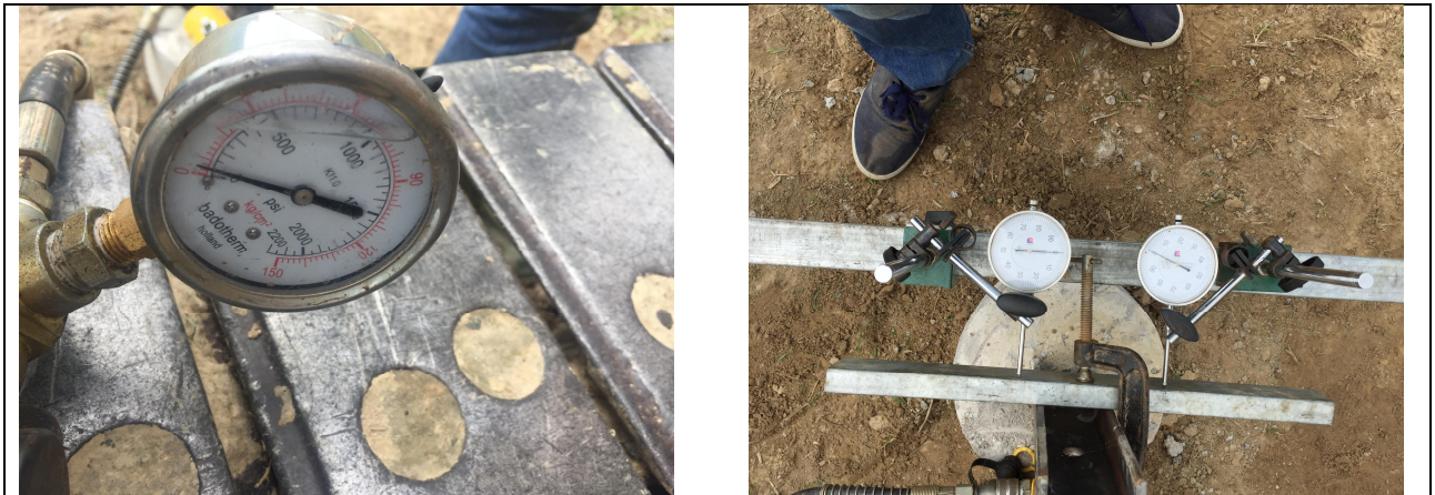
Số đọc đồng hồ ban đầu/Gauge reading at 0% Design Load
