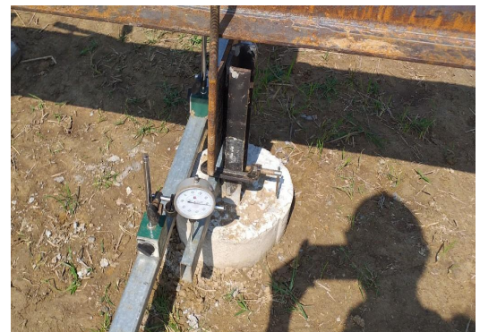
Số đọc đồng hồ tại cấp tải 200%/Gauge reading at 200% Design Load
