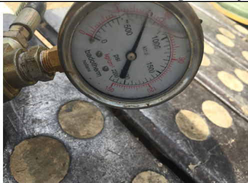
Số đọc đồng hồ tại cấp tải lớn nhất (275%Ptk)/Gauge reading at applied Load max (275%Ptk)
