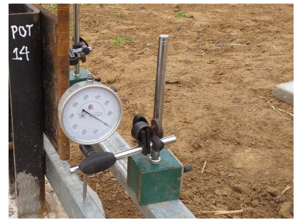
Số đọc đồng hồ ban đầu/Gauge reading at 0% Design Load
