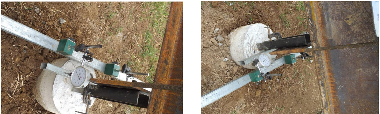
Số đọc đồng hồ tại cấp tải 100%/Gauge reading at 100% Design Load
