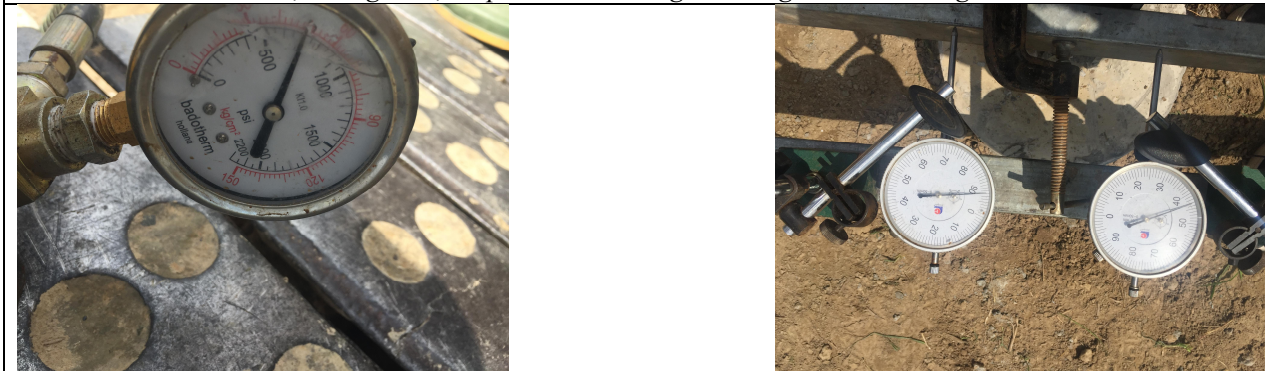
Số đọc đồng hồ tại cấp tải lớn nhất (275%Ptk)/Gauge reading at applied Load max (275%Ptk)
