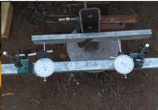
Số đọc đồng hồ tại cấp tải 100%/Gauge reading at 100% Design Load
