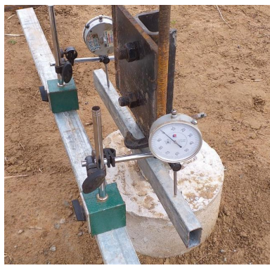
Số đọc đồng hồ tại cấp tải 100%/Gauge reading at 100% Design Load
